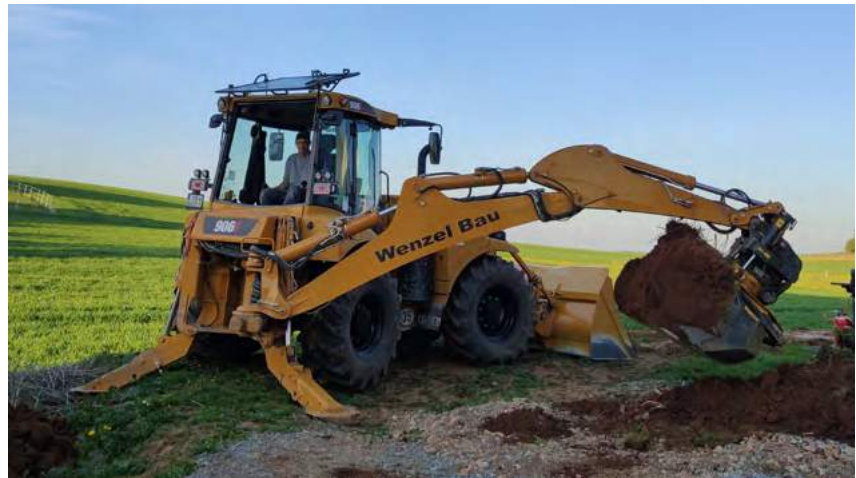
Mit dem 280 Grad Schwenkbereich kann das Material auch seitlich verladen werden.
