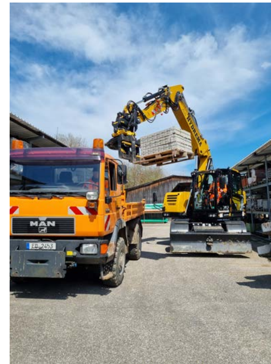
Für den MX City-Bagger müssen die Ladeboardwände nicht herabgesetzt werden, um eine Palette aufzuladen. Bildquelle: HYDREMA
