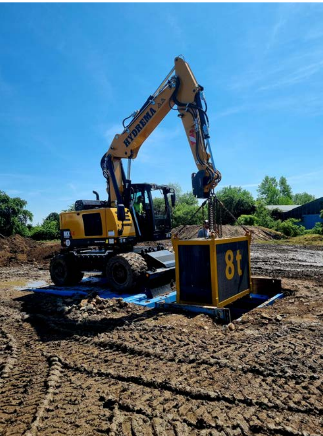
Mit dem MX14 kann man auch 8 Tonnen schwere Objekte aus dem Graben heben.
