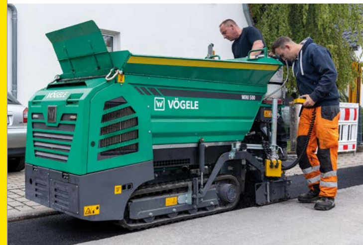
Erste Einsätze mit den neuen Mini-Fertigern: Der MINI 500 und der MINI 502 eignen sich optimal für kleinflächige Baumaßnahmen und Arbeiten auf engstem Raum.
