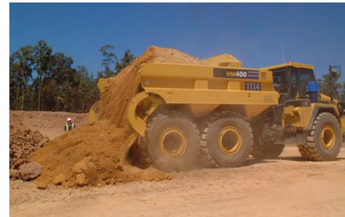
Ohne die Ladefläche des LKW zu bewegen oder anzuheben, schiebt die Auswurfschaufel eines Hinterkippers das Material zum Heck des Fahrzeuges, während sich die Heckklappe absenkt und das Material vollständig ausgeworfen wird. Die Heckauswurfmulden von Philippi-Hagenbuch machen ein Anheben der Ladefläche überflüssig und ermöglichen so ein sicheres Auskippen von Material während der Fahrt und bei Überkopfbarrieren.
