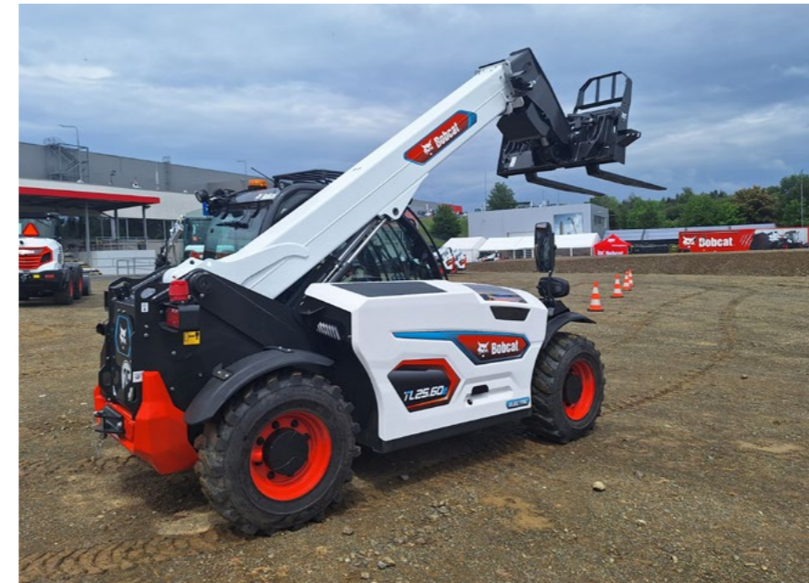
Prototyp eines elektrischen Teleskopladern TL25.60e Bildquelle: Patrik Eder, LECTURA GmbH
