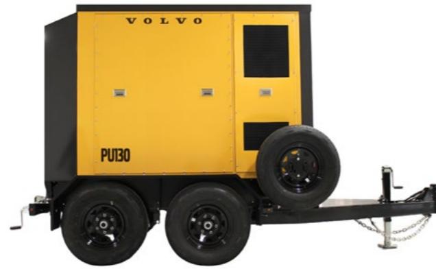
Der PU130 kann ein elektrisches Gerät in 30-45 Minuten laden Bildquelle: Portable Electric
