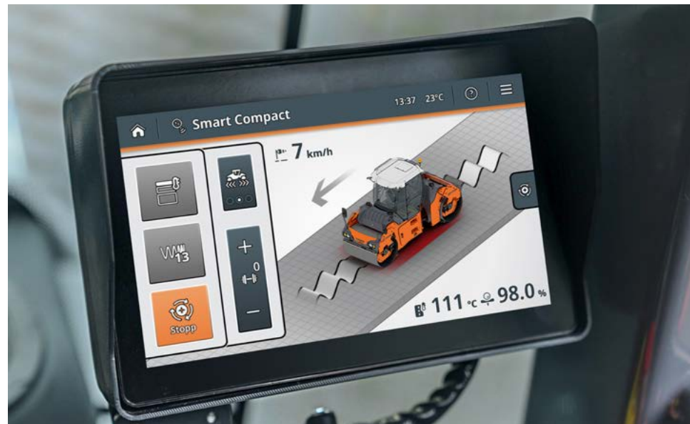
Integration von Echtzeit-Dichte in Hamm Smart Compact: Die automatische Regelung der Verdichtungskraft und -modi auf Basis der Echtzeit-Dichte (im Display unten rechts in %) bietet entscheidende Vorteile für Baufirmen bei der qualitativen Beurteilung der Verdichtung. Bildquelle: Wirtgen Group
