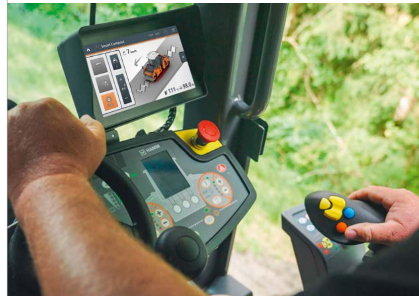
Leichte Bedienung: Smart Compact Pro lässt sich intuitiv über das zugehörige Display bedienen. Höchste Verdichtungsqualität, die durch die automatisierte Verdichtung auf Basis der Echtzeit-Dichte erzielt wird, ist dadurch auch ohne jahrelange Erfahrung möglich. Bildquelle: Wirtgen Group
