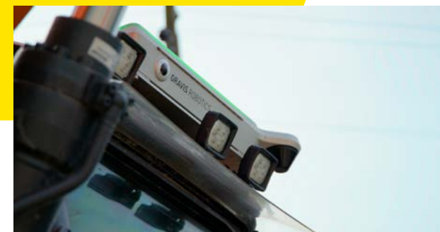
Detailansicht: Das Gravis-Rack, ein dachmontiertes System liefert die volle LiDAR-Abdeckung für 3D-Scans der Umgebung. Bildquelle: Gravis Robotics
